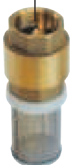
VALVOLA DI FONDO 1" gas F completa di valvola di non ritorno e filtro in rete in acciaio
